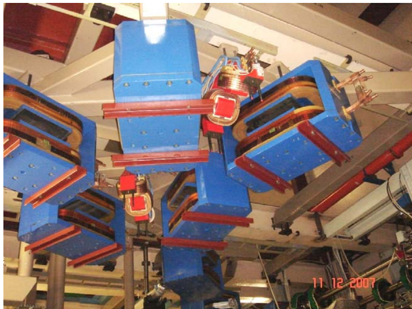
Рис. 32. Поворотные магниты и верхние половины квадрупольных линз перед установкой вакуумных камер.
